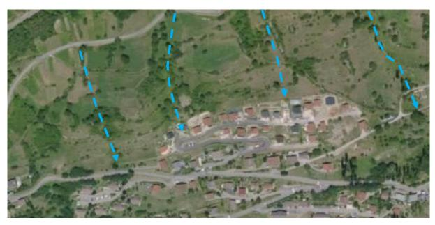
Figure 10 : sources possibles des coulées boueuses
