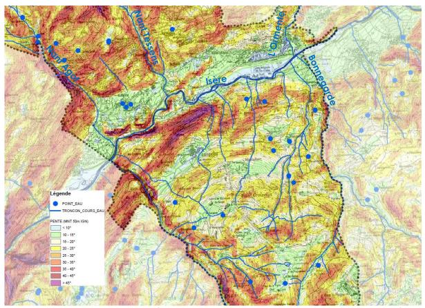
Figure 3 : carte des pentes, du réseau hydrographique et des points de sources (données IGN, traitement RTM)
