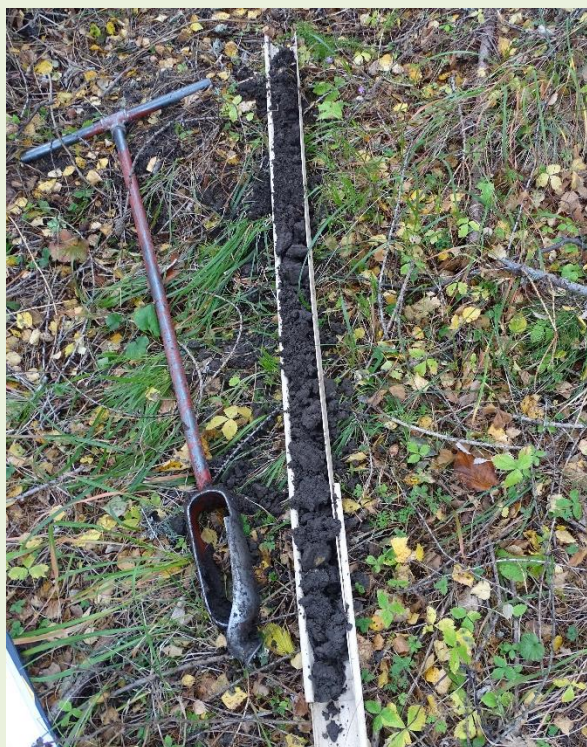
Sondage n°3 : : Pas de traces significatives au-dessus de 50 cm – Sol non humide.
